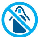
Stellen Sie die Geräte niemals in die Nähe eines Vorhanges. Legen Sie keine Kleidung, Decken oder Gardinen auf das Sauerstoffgerät. Die Materialien könnten sich bei einer undichten Stelle mit Sauerstoff anreichern und leichter entzünden.
